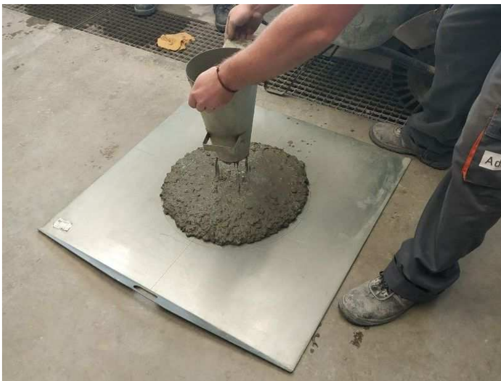
(2) Obr. 2 – Zkouška rozlití směsi SCC metodou obráceného kužele (dále jen Zkouška rozlití SCC)
