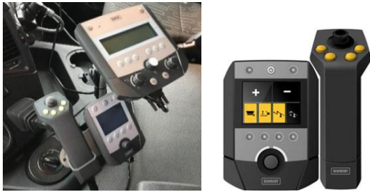
System ovládání pluhu a čelních nástaveb Schmidt ESC-A a ESC-J
