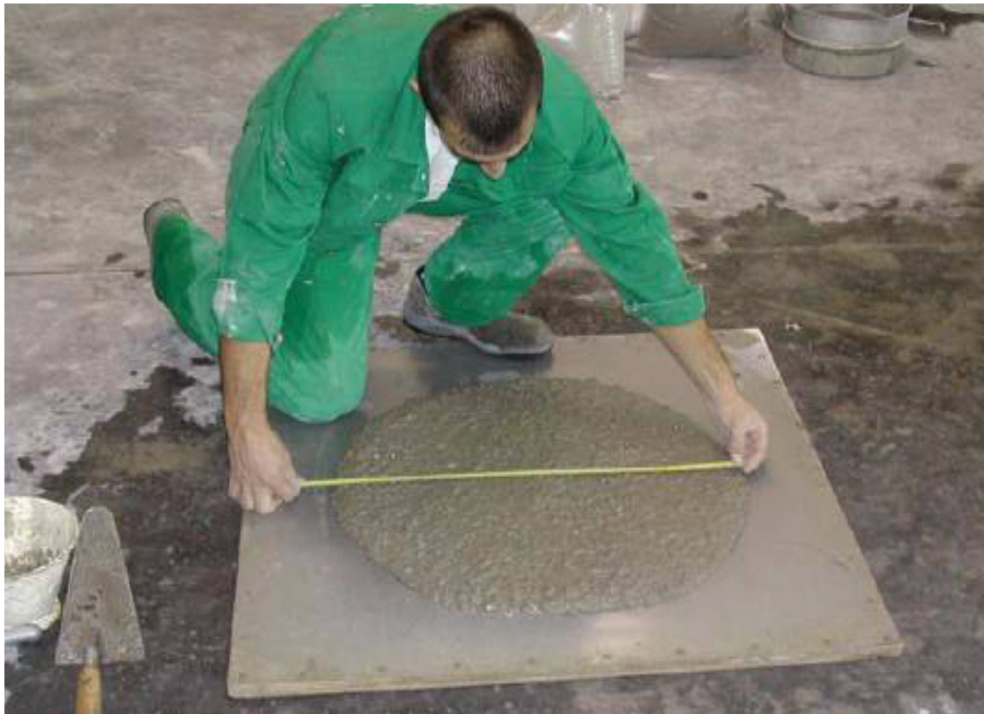
(3) Obr. 3 – Zkouška rozlití SCC - správně navržená směs
