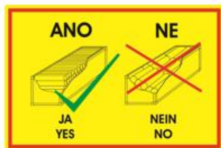
Obrázek 2: Ložení kulatiny 2m do vozů s kontejnerovou nástavbou (AgroTainer)
