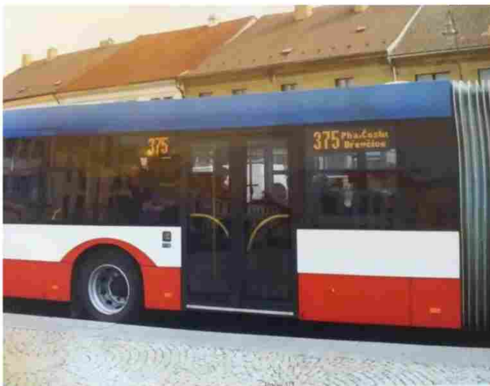
Obrázek 6: Nesprávné použití rozděleného bočního panelu
