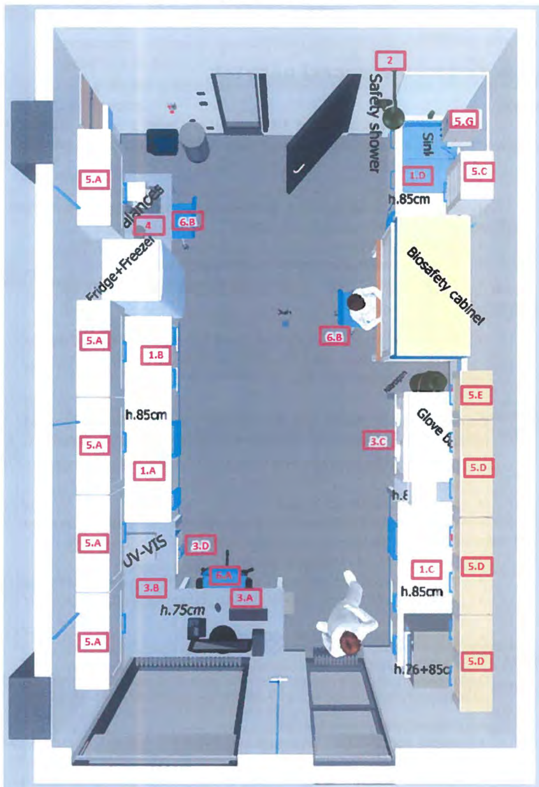
Obr. 2 - 3D vizualizace návrhu do laboratoře BioChemLAB LB.1.05 – svrchní pohled.
