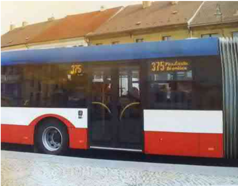
Obrázek 6: Nesprávné použití rozděleného bočního panelu
