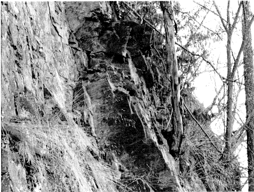
Příloha 2: Detailní foto deskovité odlučnosti břidličného masivu, po změření objemů byly obdobné bloky uvažovány do pádových simulací
