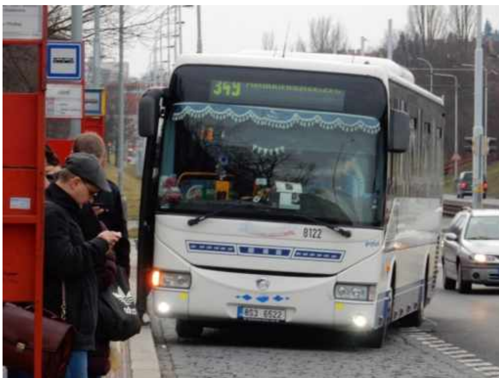
4: Nesprávné zobrazení informací na předním informačním panelu
