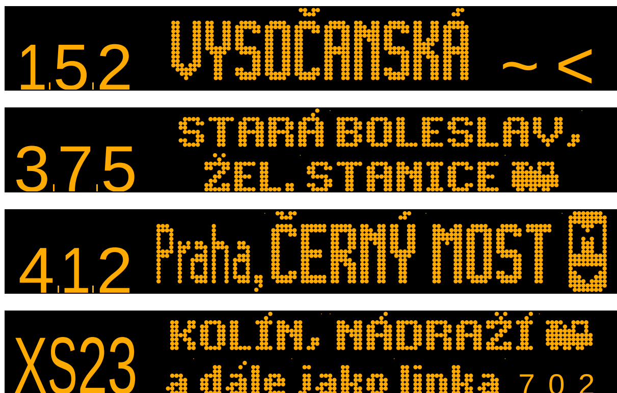
Obrázek 3: Zobrazení informací na předním informačním panelu
