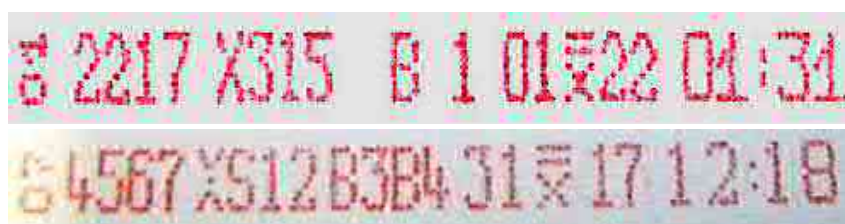
Obrázek 16: Požadovaný tisk z označovače jízdenek
