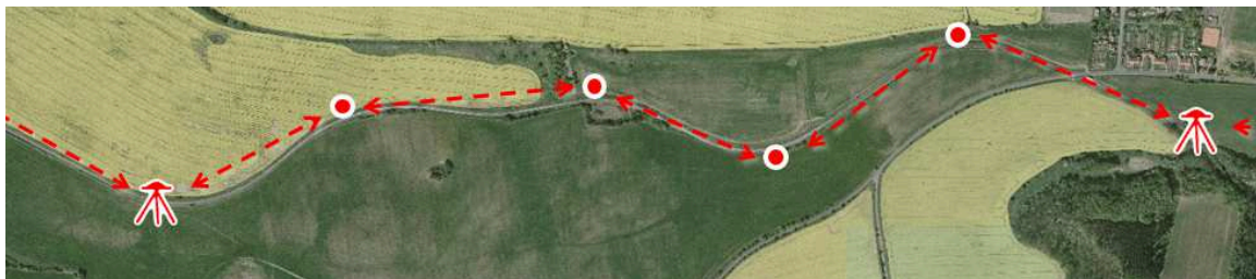
Obrázek 28 Geodetické body (GB) mezi základními geodetickými body (ZGB)
