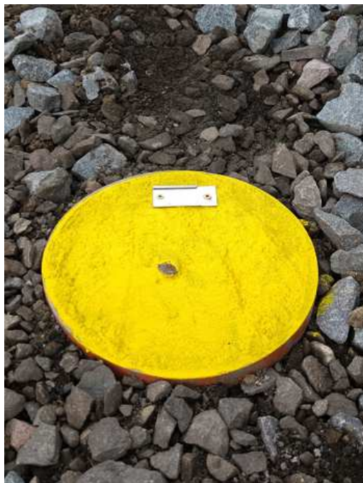
Obrázek 36 Schéma a ukázka základní odlehčené stabilizace
