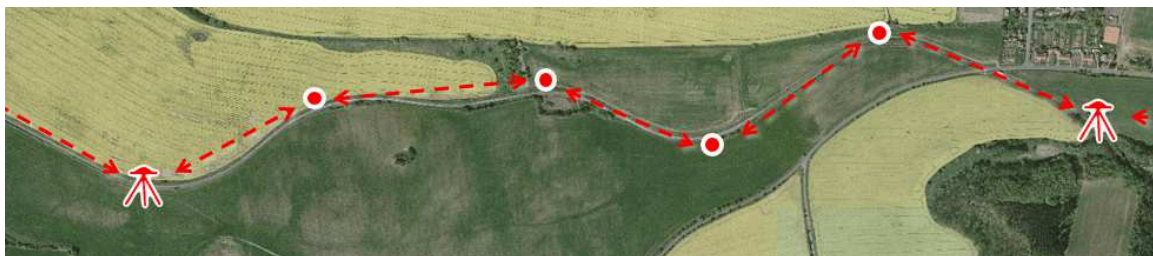
Obrázek 1 Polygonové body mezi dvěma body primární sítě
