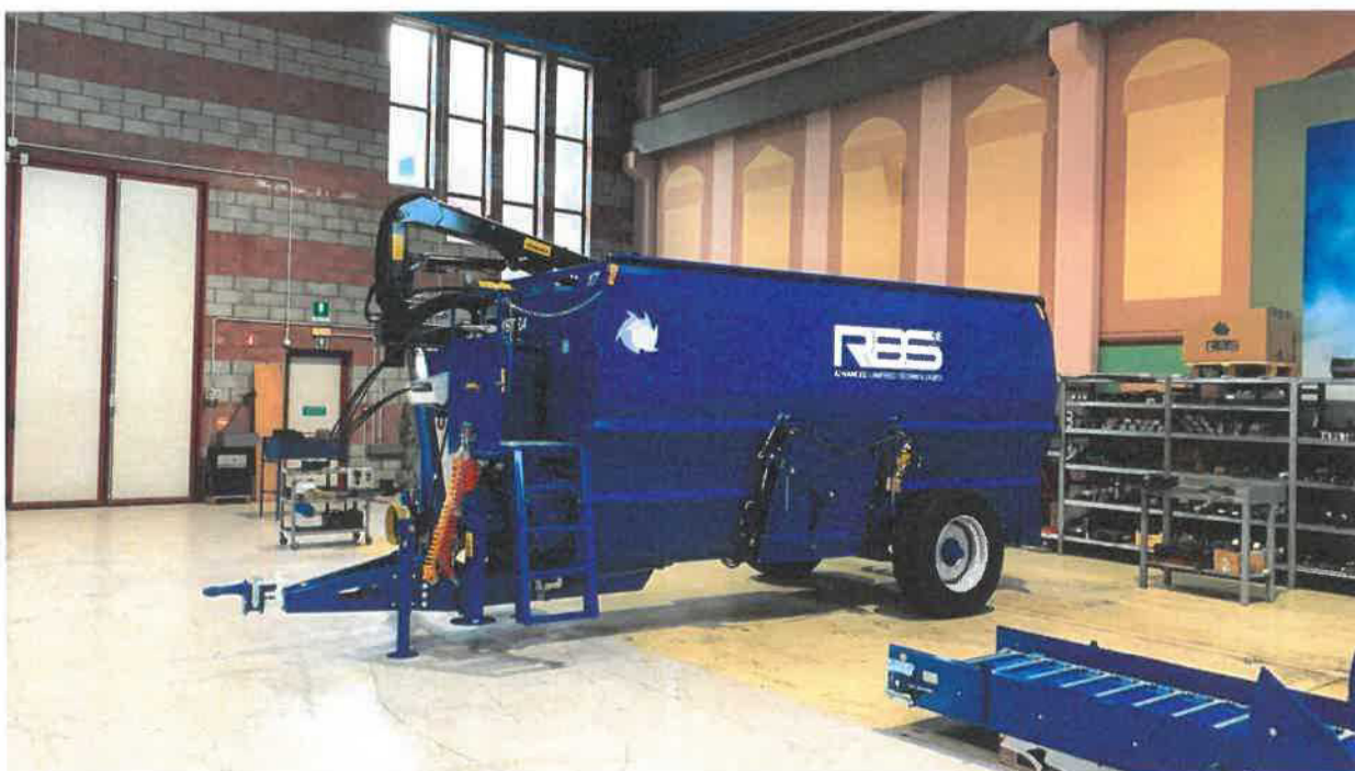
Schůdky na ovládací a kontrolní plošinu před míchací vanou, na boku vyprazdňovací otvor, na zemi řetězový vynášecí dopravník
