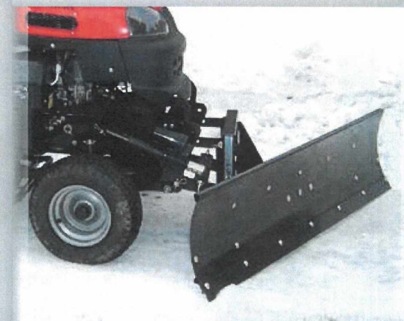
hydraulický přední závěs a radlice 140 cm
