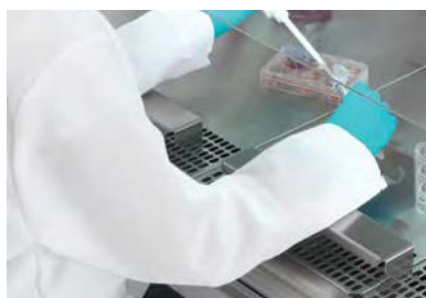
Obr. HeraSafe 205, opěrky na ruce, pracovní plochy, celoobvodové hermetické těsnění
