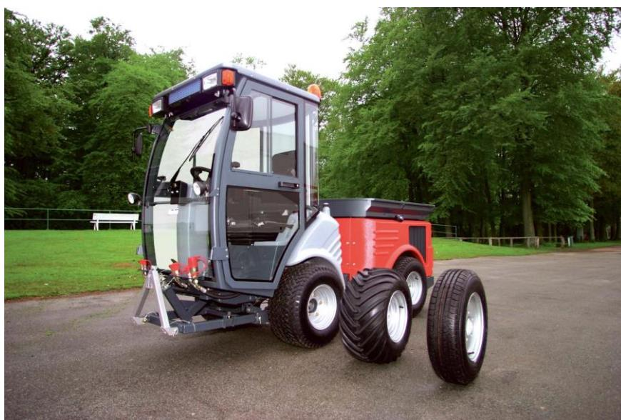
**Na stroj je možné dodat široké pneu pro nezpevněné povrchy resp. nižší měrný tlak na povrch**
