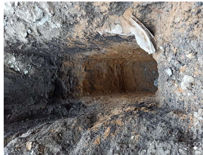
Foto 1: Profil sondy S1 ve dně stavební jámy
