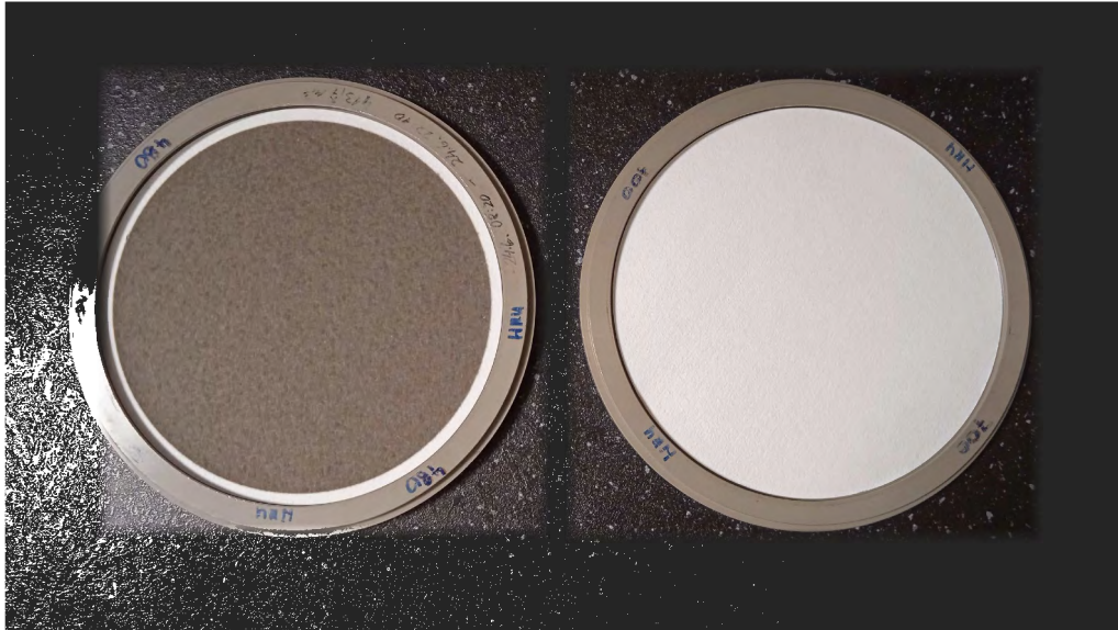
Obr. č. 3 – čistý a exponovaný filtr pro stanovení PAU v ovzduší
