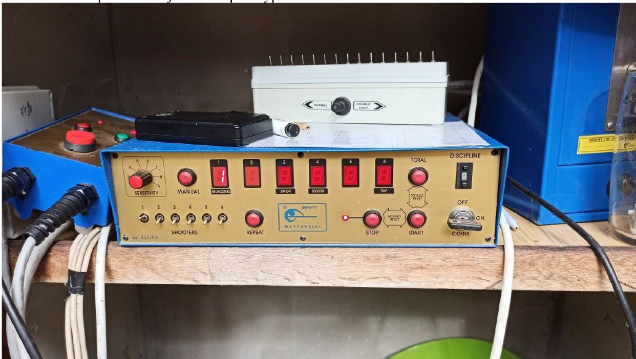
Foto č. 1 - Elfipa – řídicí jednotka pro vypouštění terčů
