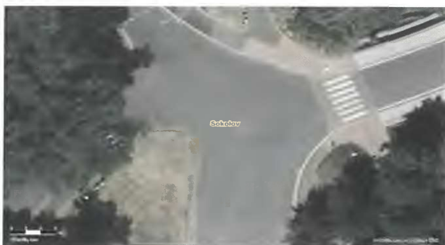
SO 18 - Oprava povrchu parkoviště s novými obrubníky a opravou odvodnění Cca 1 920 m 2 .
