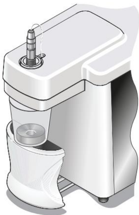
Obr. 4: Reaktor s větším objemem a vložkou pro zmenšení počátečního objemu vzorku. K tomuto bude možné připojit teploměr.
