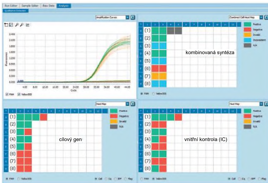
Obrázek 6: Modul kvalitativní detekce poskytuje kombinovanou syntézu získanou kombinací jednotlivých syntéz cílového genu a vnitřní kontroly.
