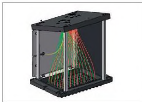
Obrázek 1: Inovační optika. Optický systém přístroje LightCycler® 96 přihlášený k patentování obsahuje dvě robustní sady 96 optických kabelů, z nichž jedna přivádí do každé jamky excitační (zelené) světlo a druhá zachycuje emitované (červené) světlo z každé jamky. Referenční kanál je znázorněn žlutě.
