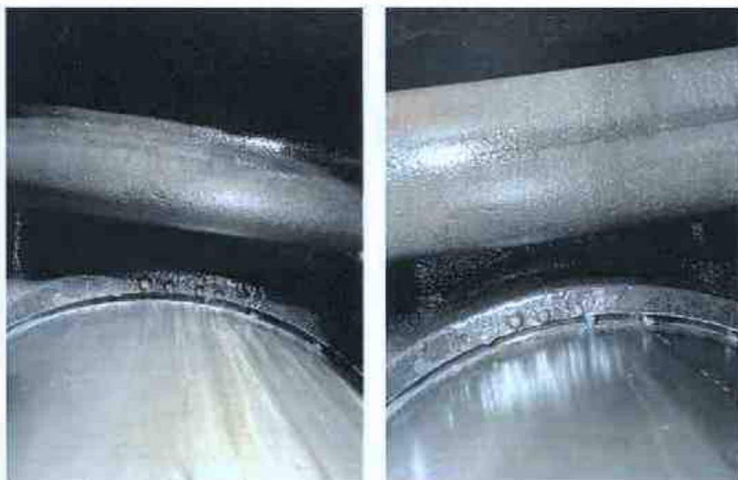
Místa největších netěsností v utěsnění vodního prostoru vložky 4. a 5. válce.
