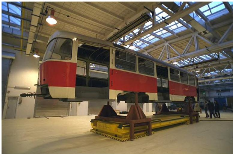
Das LRF-22 dient dem Transport von Straßenbahnwagenkästen in der Reparaturwerkstatt.
