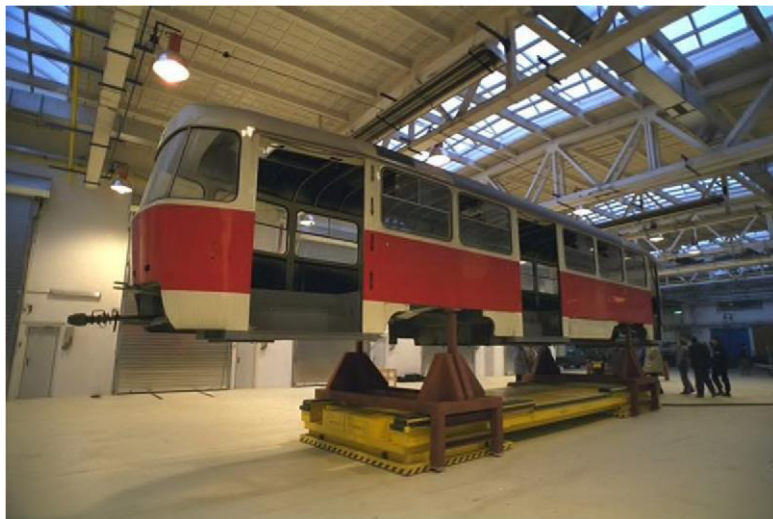
LRF-22 slouží k přepravě tramvají v opravně.
