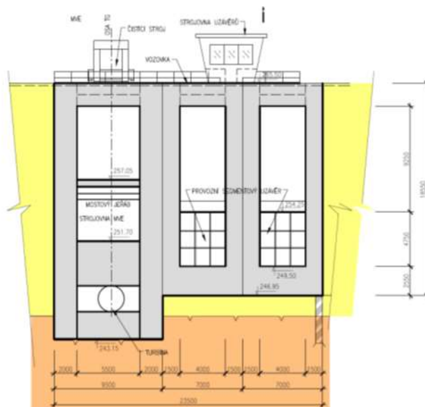
Obrázek 7: – funkční objekt - podélný řez (bez MVE) [12]
