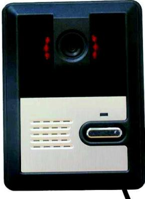
Bezdrátová dveřní stanice, podpora spojení 2,4 GHz, dosah až 300 m. Krytí IP44, barevná kamera CMOS 1/4", infračervený přísvit, tlačítko zvonku. Systém videovrátného může obsahovat až 2 dveřní stanice a 2 monitory. Podporovány jsou i systémy 2 on 1 (2 monitory, 1 dveřní stanice) a 1 on 2 (1 monitor, 2 dveřní stanice). Systém pracuje v pásmu 2401MHz až 2483MHz, přičemž automaticky pomocí funkce FHSS pásmu 2,4GHz zvolí nerušenou frekvenci.
