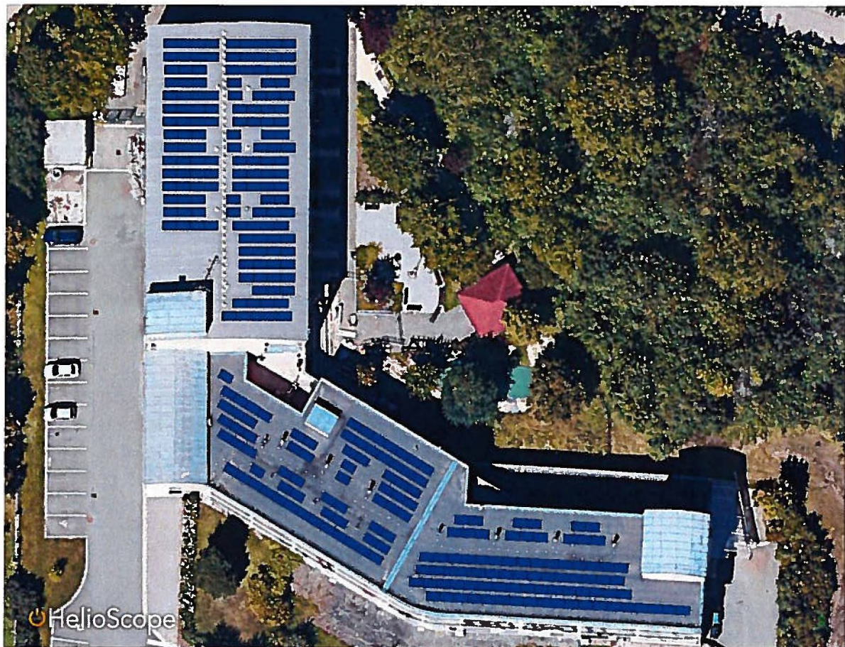
Obrázek č. 3.3.8.3: Rozložení FV panelů - modelové řešení
