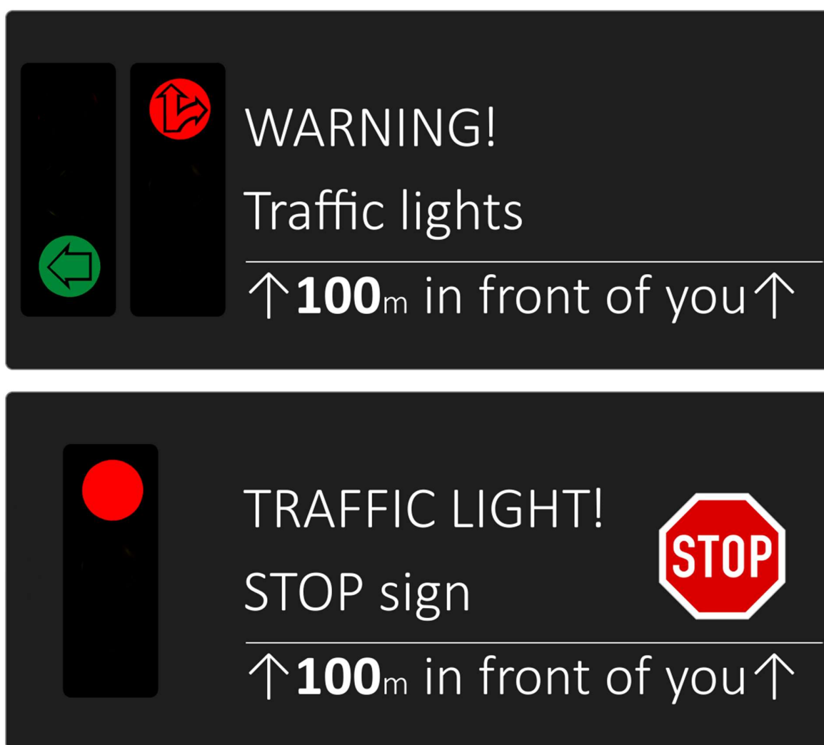
Obrázek 50: Možnost prezentace zprávy v rámci služby ISV (stav SSZ) na displeji ve vozidle
