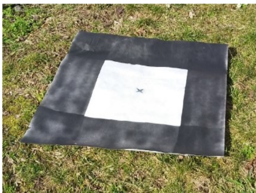
Obr. 2. Rozměry a způsob signalizace bodu geotextilií
