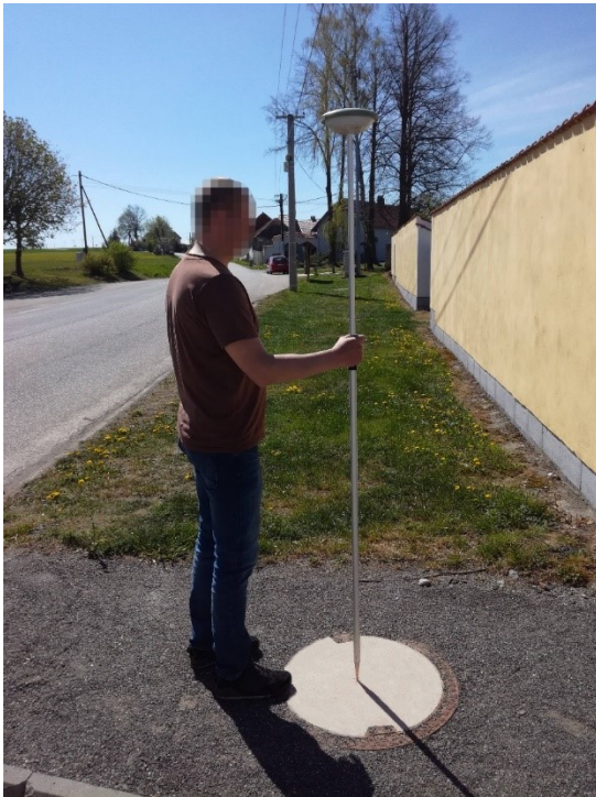
Obr. 4: Ukázka zaměření SVB technologií GNSS
