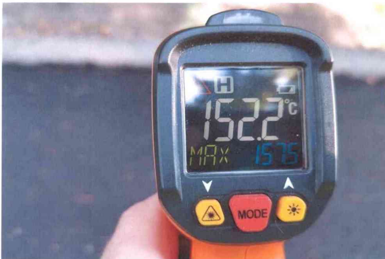
teplota asf. směsi při pokládce ACL 16+
