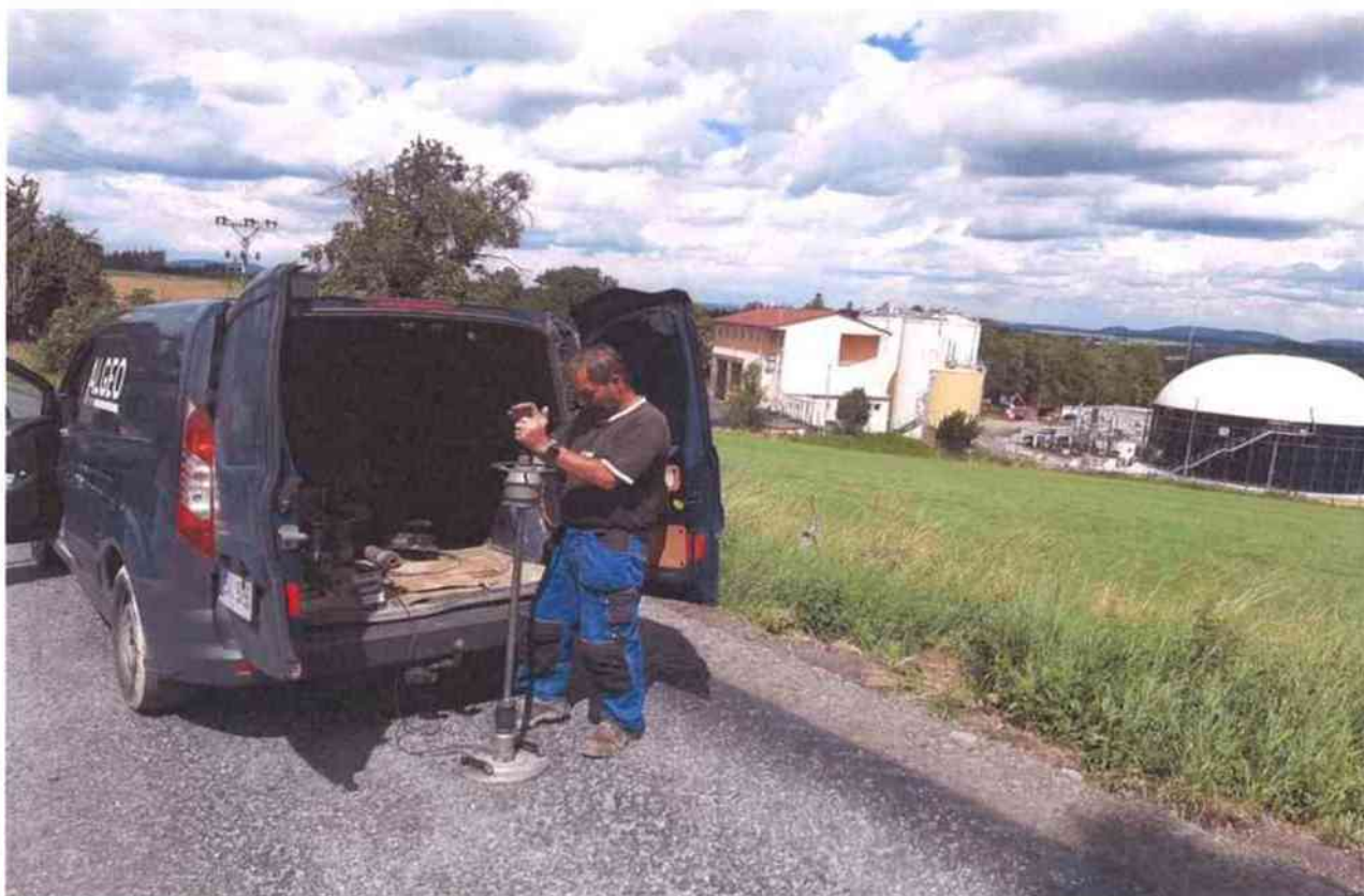
provádění dyn. zkoušek na recyklaci za studena
