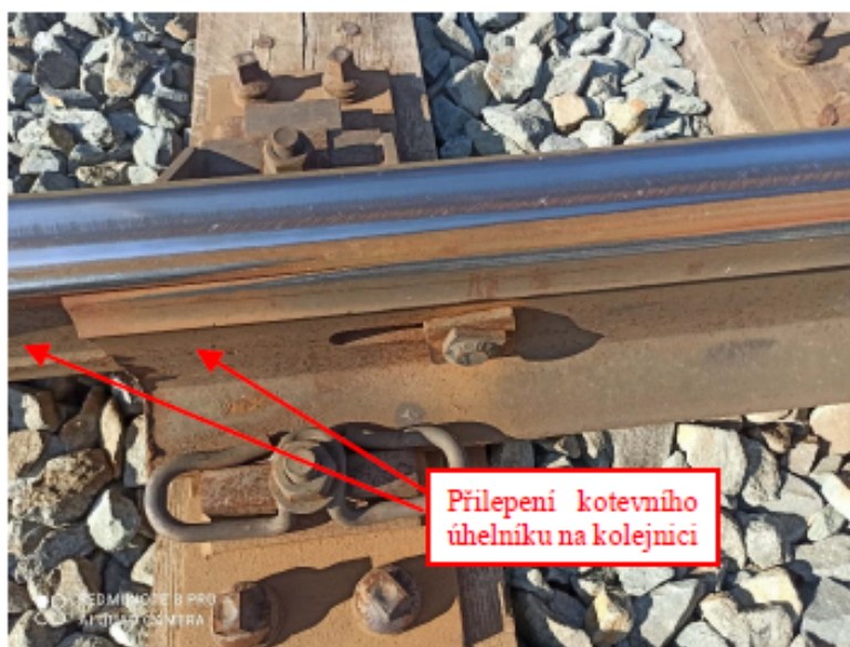
Obr. 20 Příklad uchycení relativního snímače pro měření posunu kolejnice vůči NK
