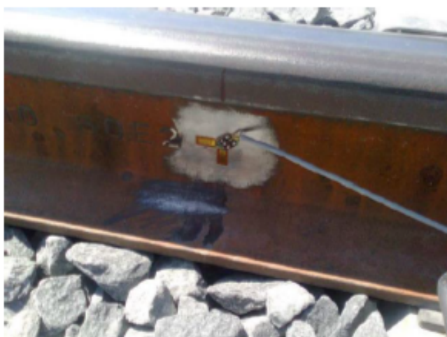
Obr. 12: Způsob zapojení tenzometrického polomostu – aktivní tenzometr v podélném směru, kompenzační tenzometr ve svílem směru
