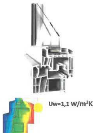
Dvojitě zasklení 24 mm Hliníkový distanční rámeček
