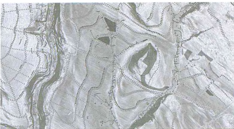
Obr.21: Celkové řešení nad sklonovým 3D vyjádřením barevně pro závěrečnou kontrolu ekvidistance návrhu řešení vrstevnicových kontur. DMR 5G, ČÚZK.
