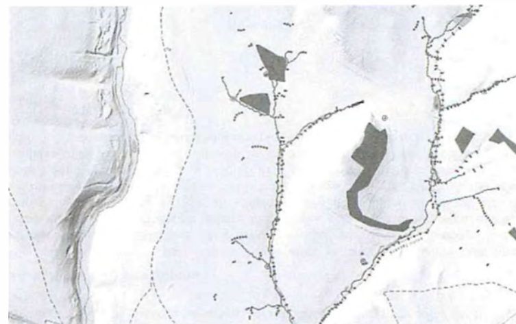
Obr.7: Návrhy upravení – obnova hydrologické funkce údolnic podklad i díl DMRG 5G ČÚZK
