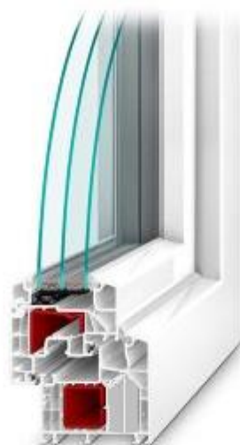
Pasiv CL85 - 6 komorový 85mm profil, 3 těsnění, izolační trojsklo Ug=0,6/0,5 W.m-2.K-1
