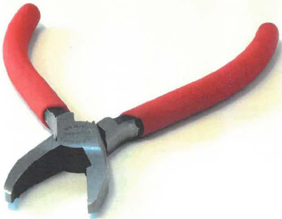
Mozaikové kleště/např. Leponitt nebo model vyšší řady BOHLE ZAG ZAG Mozaikové kleště
