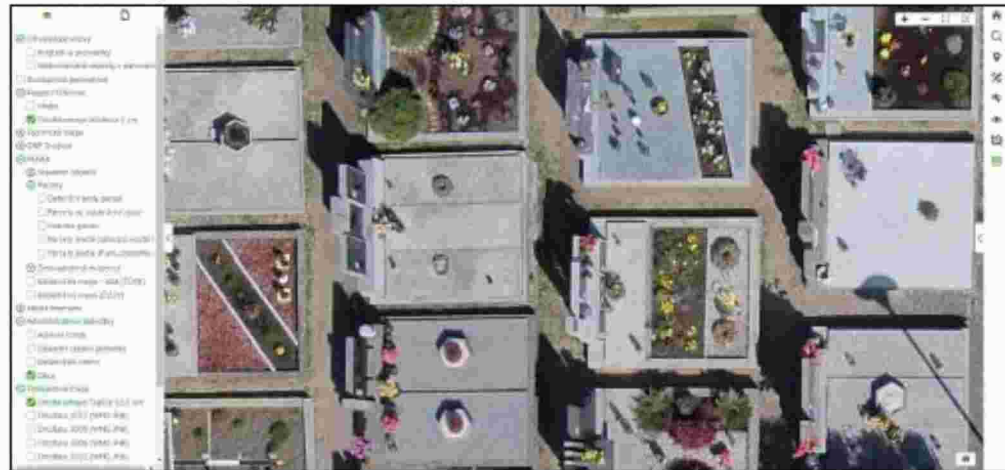
Obr. Ukázka ortofotomapy hřbitova- rozlišení 2cm/pixel
