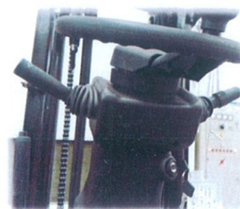
Vzdálenost ovlad.pojezdu jen 65mm od volantu.
