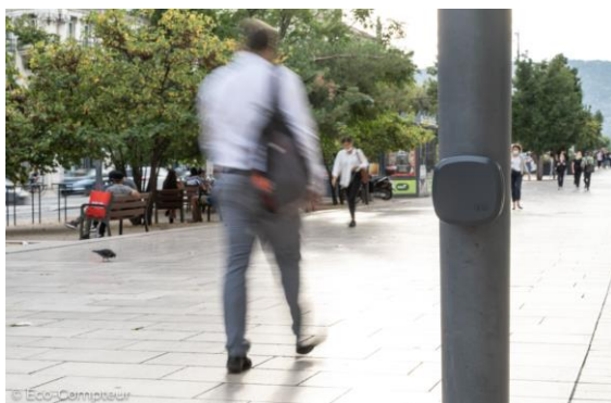
Umístění sčítače na sloupu veřejného osvětlení
