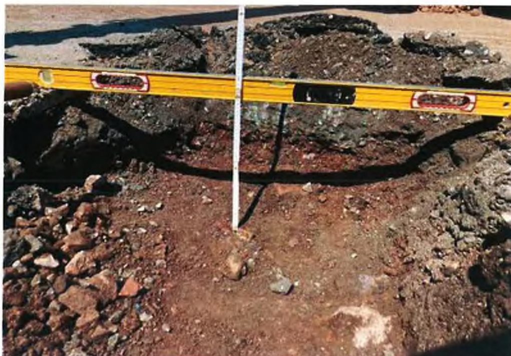
Úsek č.8 bez původní sanace HDK 0/250 -podloží jemnozrnná zemina
