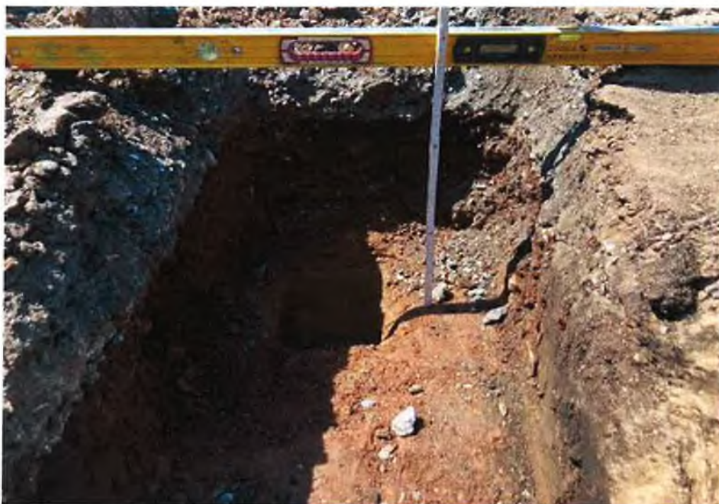
Úsek č.8 bez původní sanace HDK 0/250 -podloží jemnozrnná zemina
