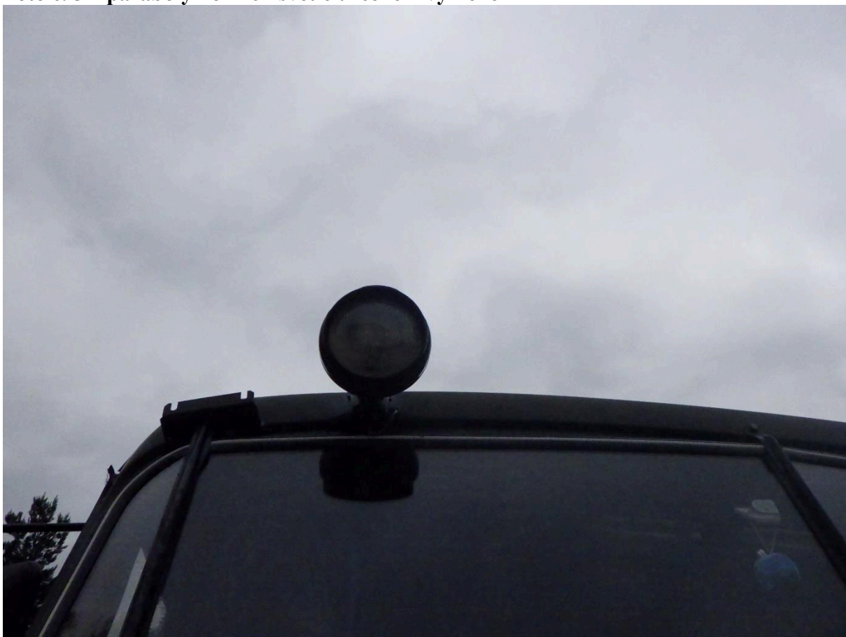
Foto č. 5 – paraboly horních světle určené k výměně
