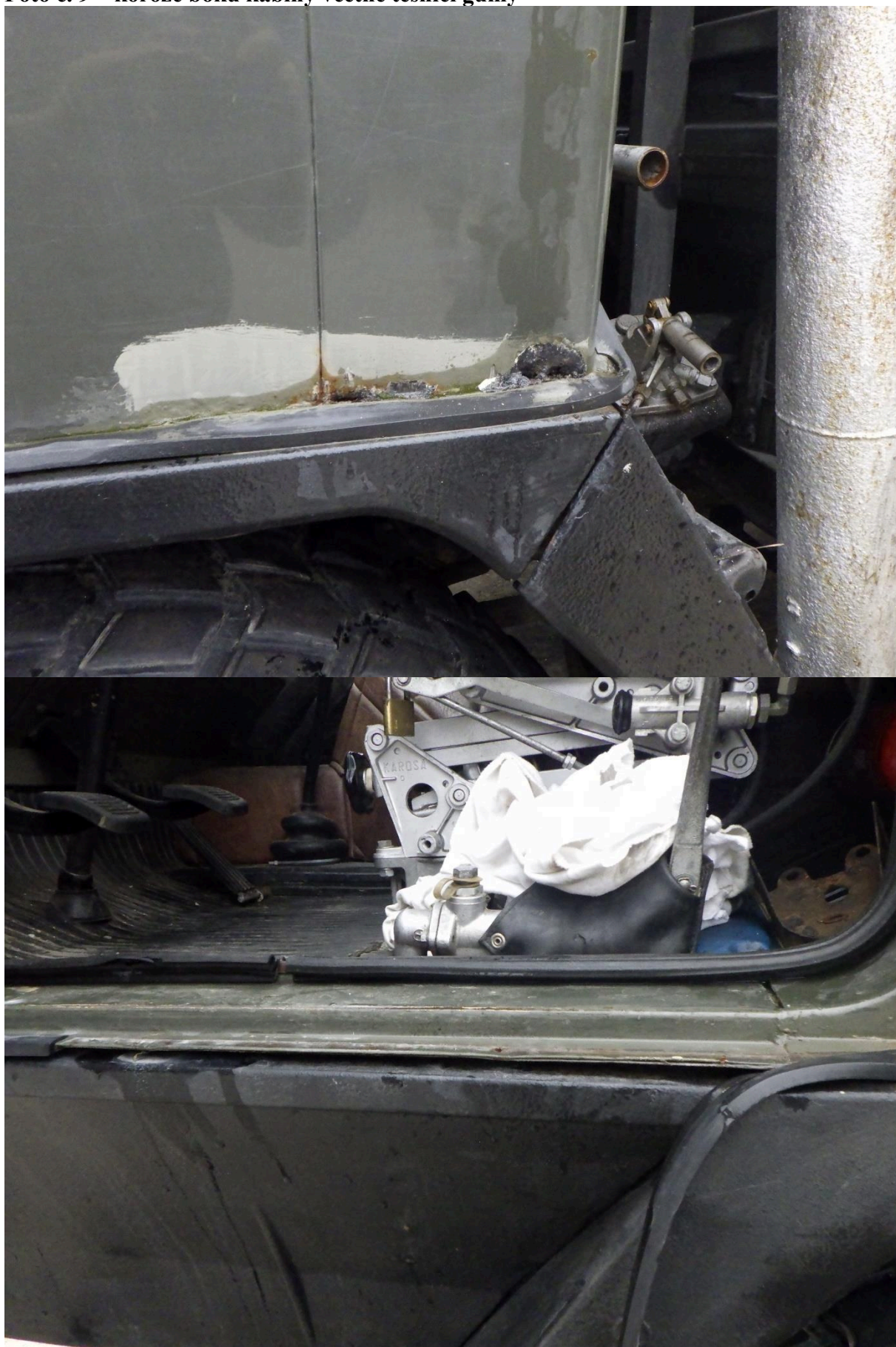
Foto č. 9 – koroze boku kabiny včetně těsnící gumy
