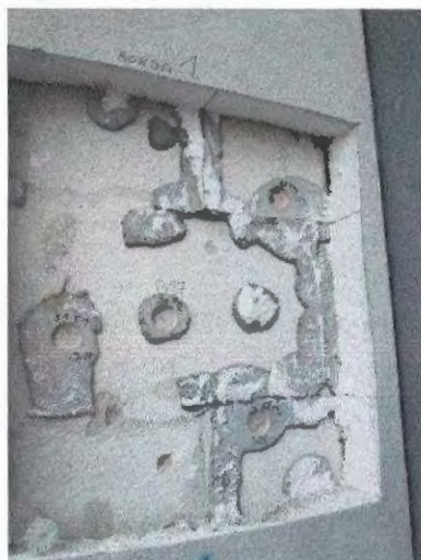
foto /35/ Sonda 1 ze zkoušky přídržnosti ([4])
