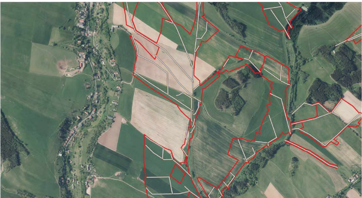
Obr.12: Výkres hlavníků a hranic odvodněné oblasti podle projektové dokumentace mel. systémů Obr.13: Odstranění projektů meliorací po digitalizaci vedení hlavníků a per
