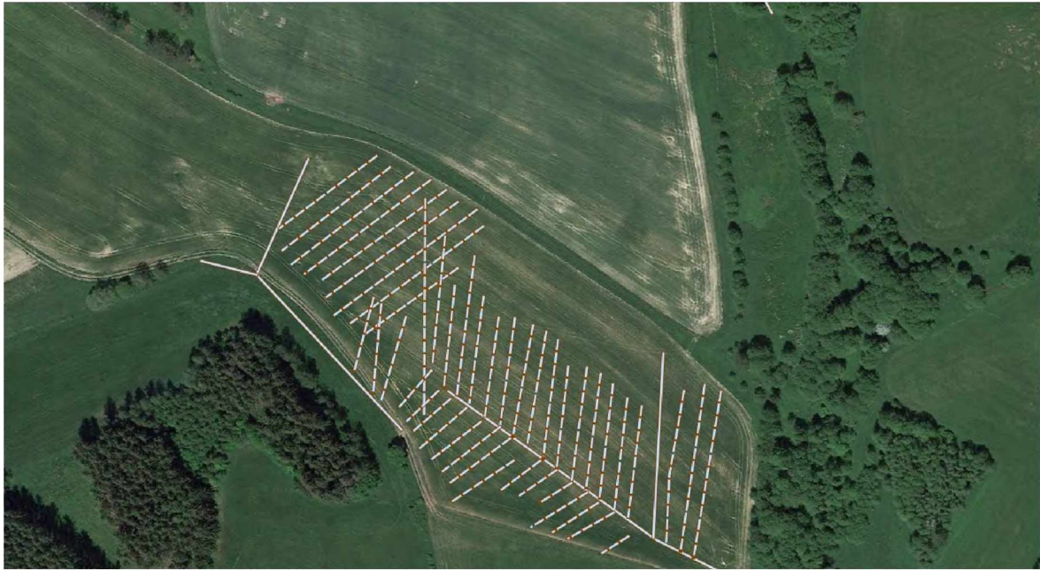
Obr.20: Ukázka zákresu DPZ melio (melio detail, čárkovaně) společně se zákresem hlavníků (plná čára) z projektové melio dokumentace. Google maps.
