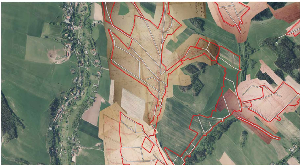
Obr.12: Výkres hlavníků a hranic odvodněné oblasti podle projektové dokumentace mel. systémů Obr.13: Odstranění projektů meliorací po digitalizaci vedení hlavníků a per
