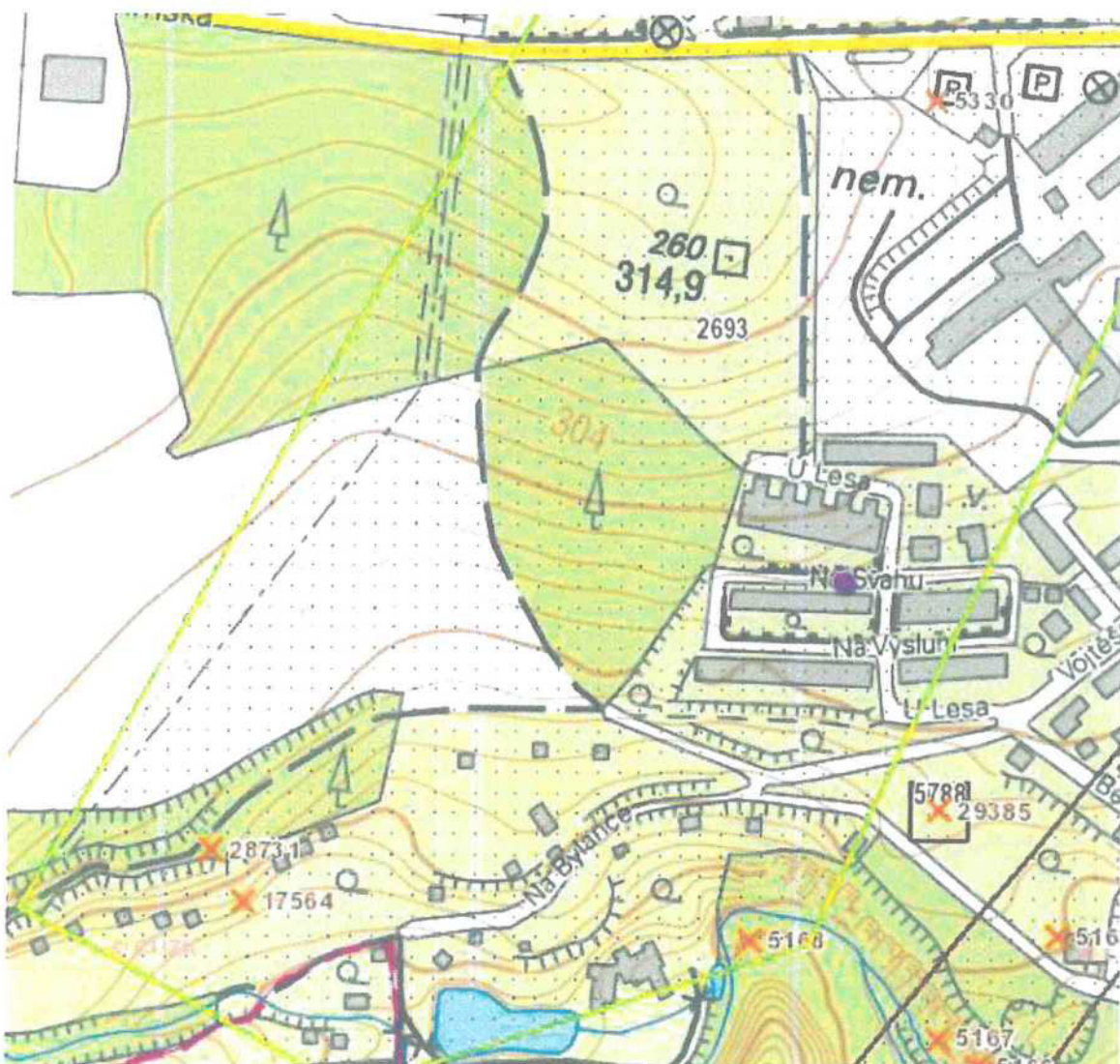
Výřez z mapy aplikace Důlní díla a poddolování . Žlutý obrys s hnědým tečkováním – poddolované území, oranžové křížky s čísly – evidovaná důlní díla, fialový bod – zájmové území.
