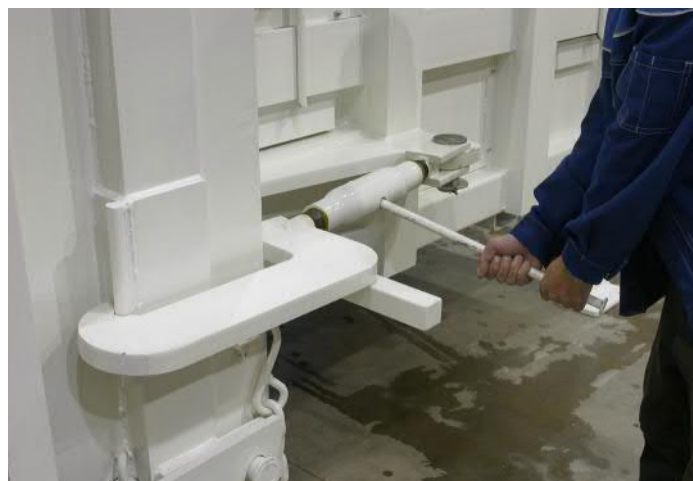
■ Detail mechanického připojení kontejneru k stacionární jednotce
