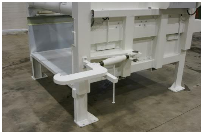
■ Mechanické připojení a hydraulické uzavírání vrat kontejneru
