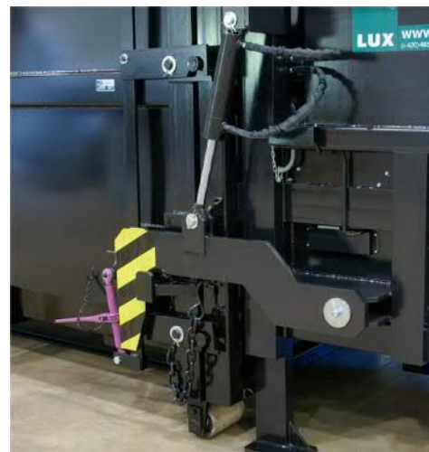
■ Detail hydraulického připojení kontejneru ke stacionárnímu lisu
