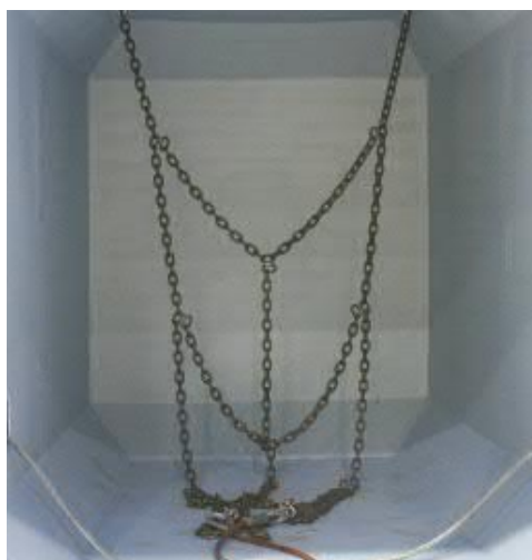
■ K dokonalému vyprázdnění kontejneru slouží „sít z řetězu“, která je umístěna uvnitř kontejneru
