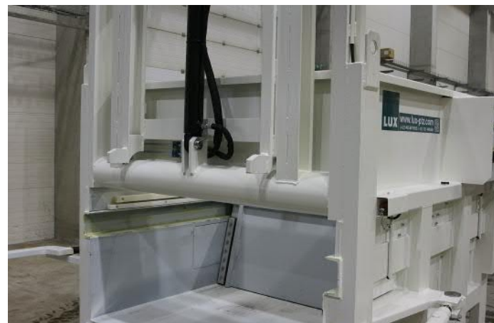
■ Mechanické připojení a hydraulické uzavírání vrat kontejneru
