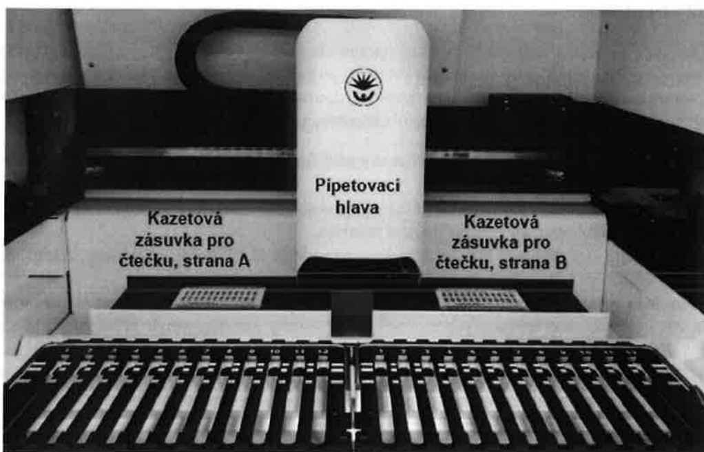
Obrázek 1-3 – Vnitřní uspořádání přístroje BD MAX
