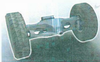
Nová náprava osazená vodo a prachotěsnými komponenty
