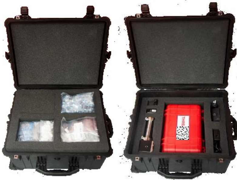
Transportní kufr s příslušenstvím pro odběr plyných vzorků (vrchní vyjímatelné plato), plynovou kvetou a spektrometrem s instalovaným ATR.
