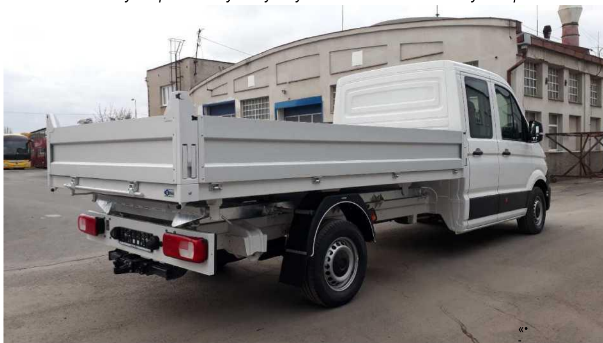
Zadní čelo - kombinované (výklopné/sklpné) s ručně ovládanými spod. zámky a zvýšeným uložením horních otočných čepů
