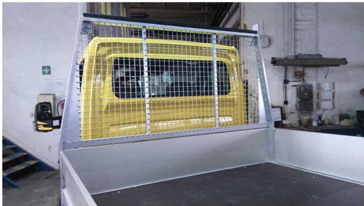
Zadní čelo - kombinované (výklopné/sklpné) s ručně ovládanými spod. zámky a zvýšeným uložením horních otočných čepů
