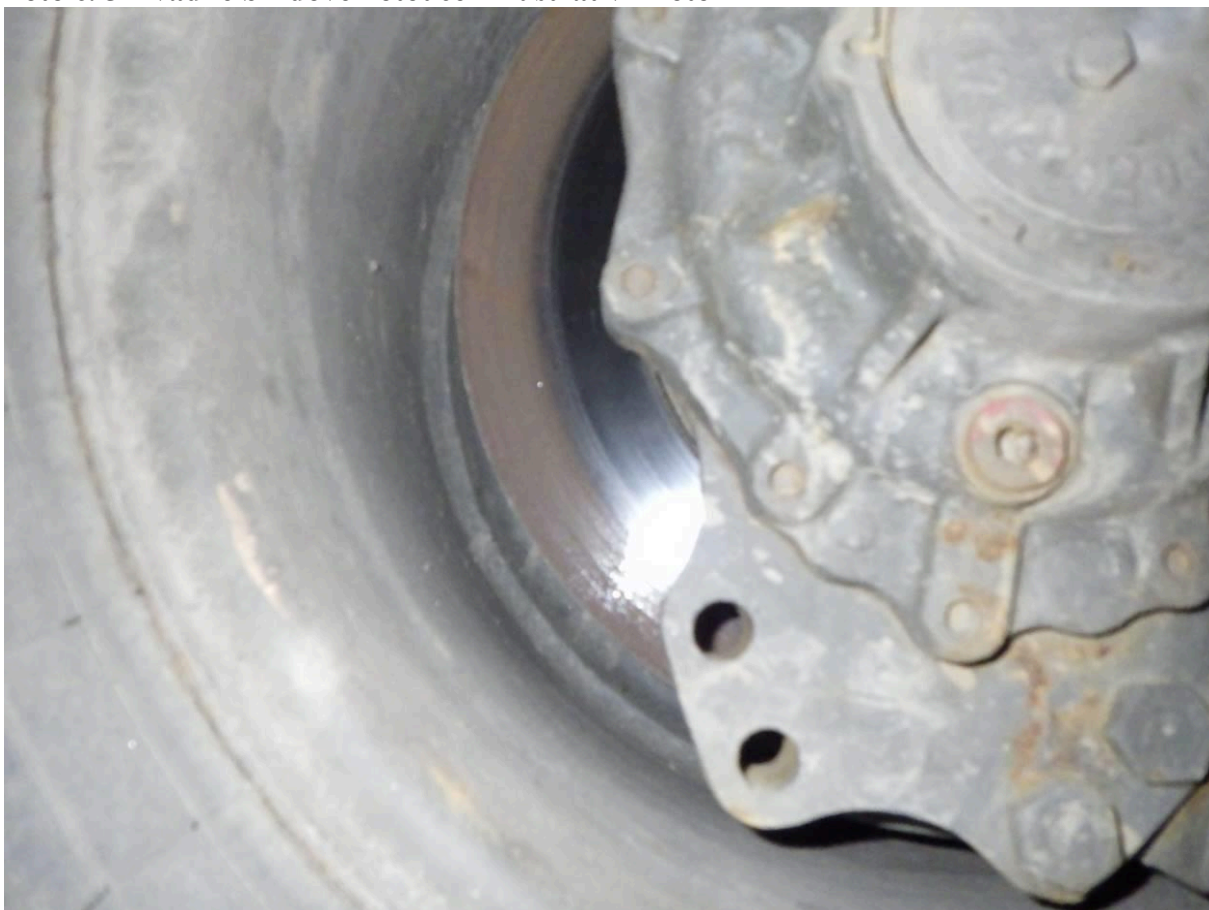
Foto č. 5 – vadné brzdové kotouče – ilustrativní foto
